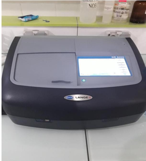
Fig. 12 : Spectrophotomètre UV-Visible (ADE, Bouira).
