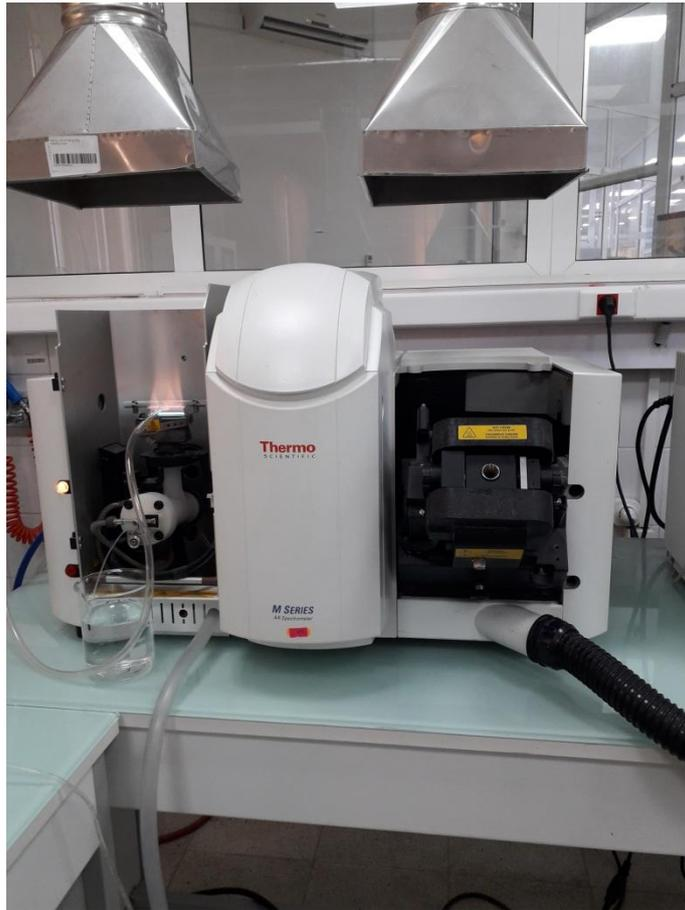
**Fig.14** : Spectromètre d'absorption atomique avec flamme (SAAF). (ADE, Alger)
